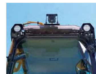
◀ Cat Commandに対応した油圧ショベルに装着されたカメラ。
