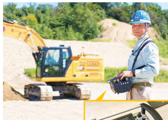
写真上: Cat Commandコンソールを使って320を遠隔操作するICT技術室課長の大枝健二様。写真右: コンソールからは最大400m離れた場所からの操作が可能。
