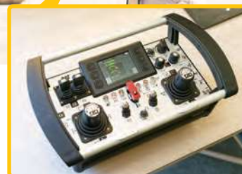
写真上: Cat Commandコンソールを使って320を遠隔操作するICT技術室課長の大枝健二様。写真右: コンソールからは最大400m離れた場所からの操作が可能。
