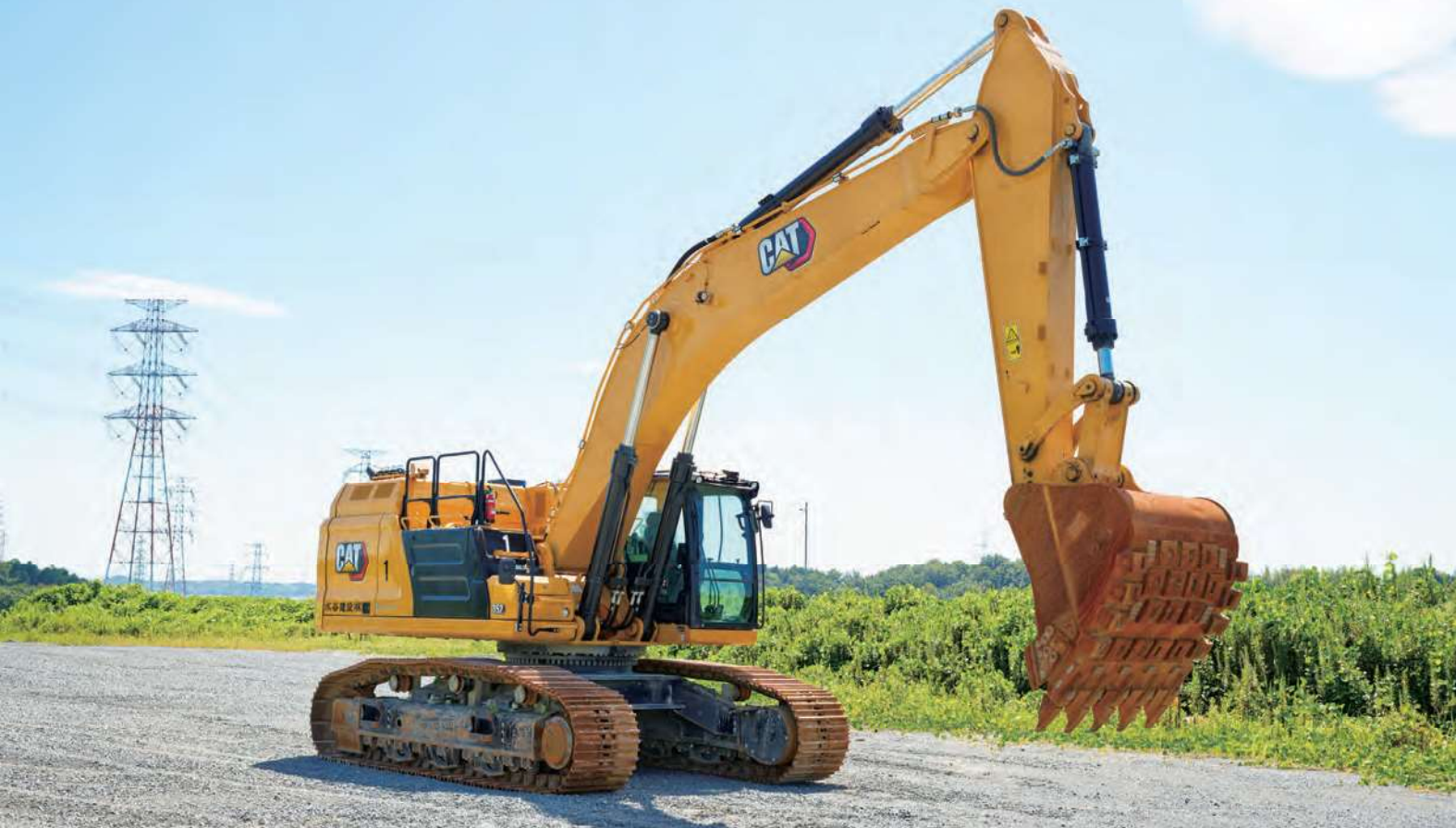
実験ヤードのCat 352。こちらもCat Commandに対応済みで、バケットは耐摩耗プレート(MAWPS)で補強されています。
