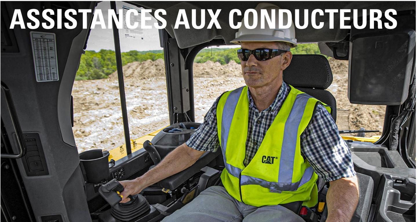
Les fonctions d'assistance facilitent le travail des conducteurs, notamment les moins expérimentés. Certaines fonctions de la lame et de la direction sont automatisées, pour permettre aux conducteurs les moins expérimentés de travailler à des niveaux de productivité plus proches de ceux de leurs collègues plus chevronnés. Les conducteurs chevronnés pourront profiter d'une réduction de leurs efforts et de leur niveau de fatigue, ainsi que de résultats plus rapides et plus précis.
