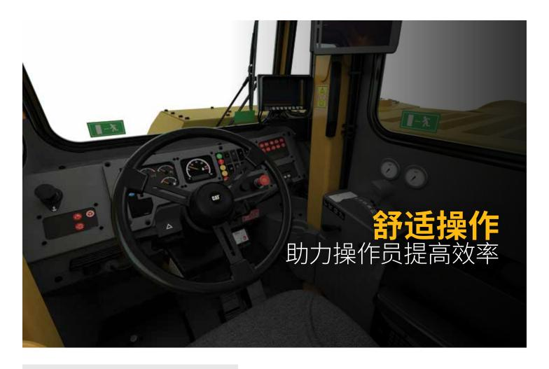
AD45 操作台的设计符合人体工程学原理,使操作员在舒适、高效、安全的环境中更有效地控制机器。控制装置、操纵杆、开关和仪表布局合理,可最大限度地提高生产率并减轻操作员疲劳。符合人机工程学并且完全可调的悬浮座椅可在长时间作业期间提供出色的舒适性。
