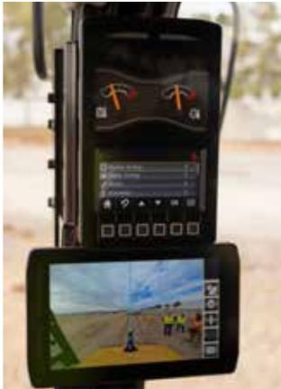
Il monitor di nuova generazione indica lo stato della macchina in tempo reale tramite un'interfaccia utente consolidata. I pulsanti a sfioramento consentono un facile accesso alle opzioni di controllo della macchina, tra cui codici di sicurezza, intervalli di manutenzione e impostazioni delle prestazioni/della risposta di attrezzatura e trasmissione.
