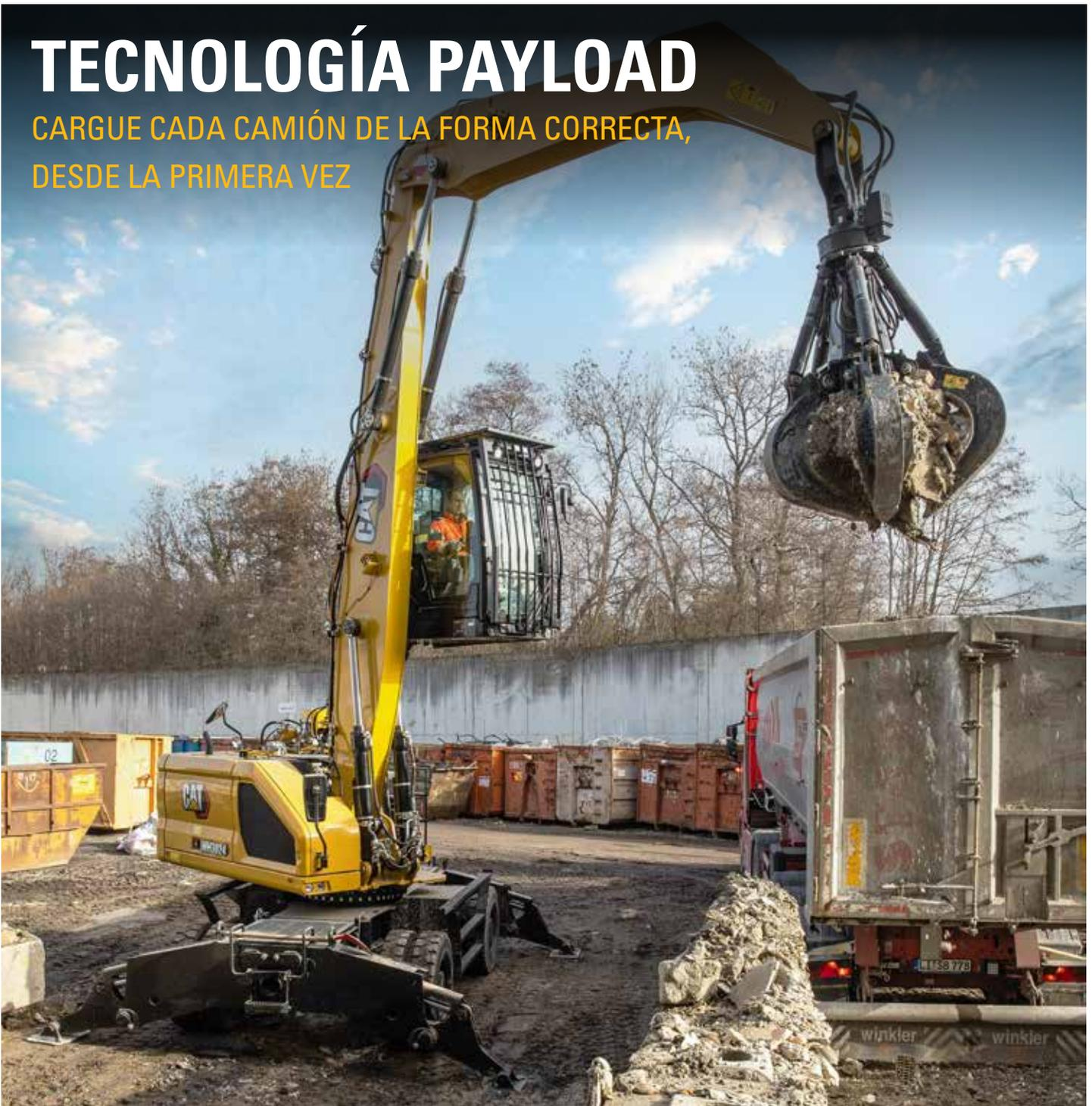
La tecnología Cat Payload ofrece pesaje de carga útil a bordo junto con valiosos datos de medición de producción y seguimiento de materiales. Estos datos están disponibles para máquinas individuales y pueden proporcionar valiosos datos sobre la eficiencia operativa de toda la flota.
