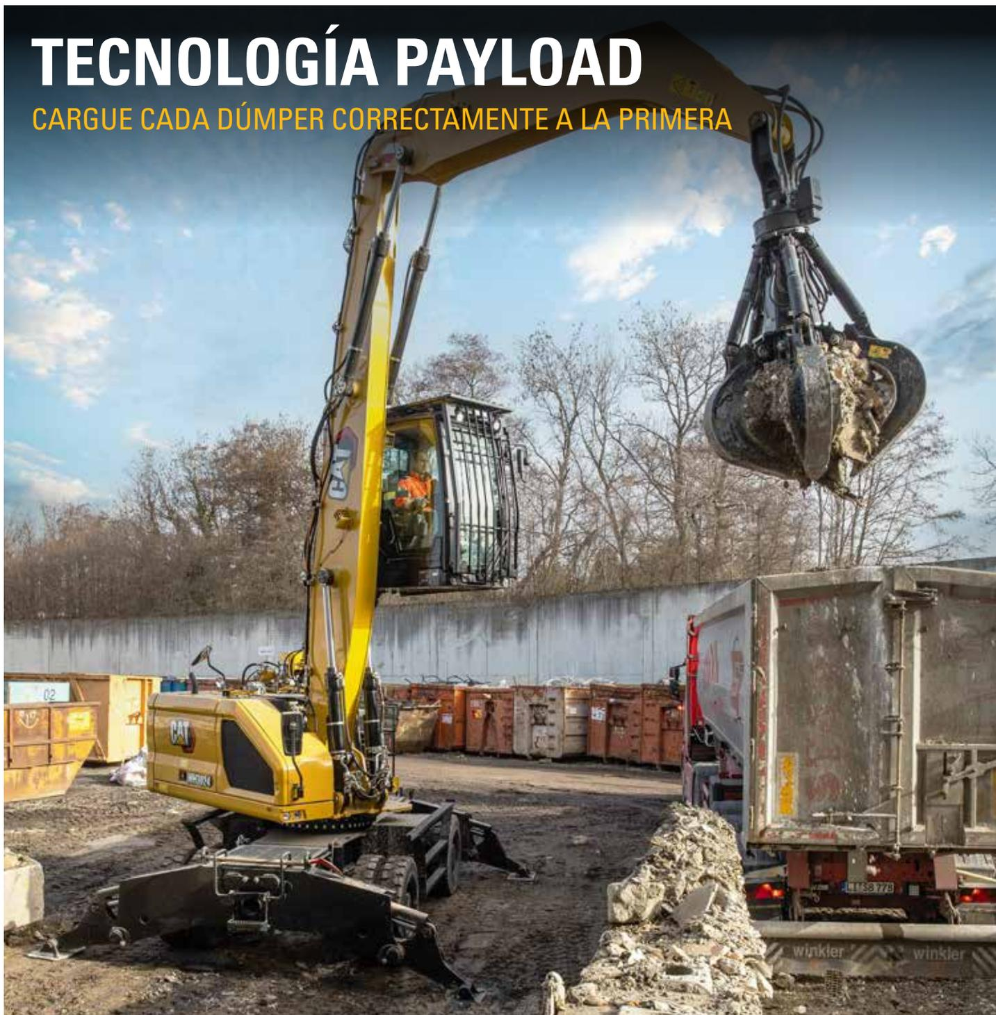
La tecnología Cat Payload ofrece pesaje de carga útil a bordo junto con valiosos datos de medición de la producción y seguimiento de materiales. Estos datos están disponibles para máquinas individuales, y además pueden proporcionar valiosos datos de eficiencia operativa de toda la flota.
