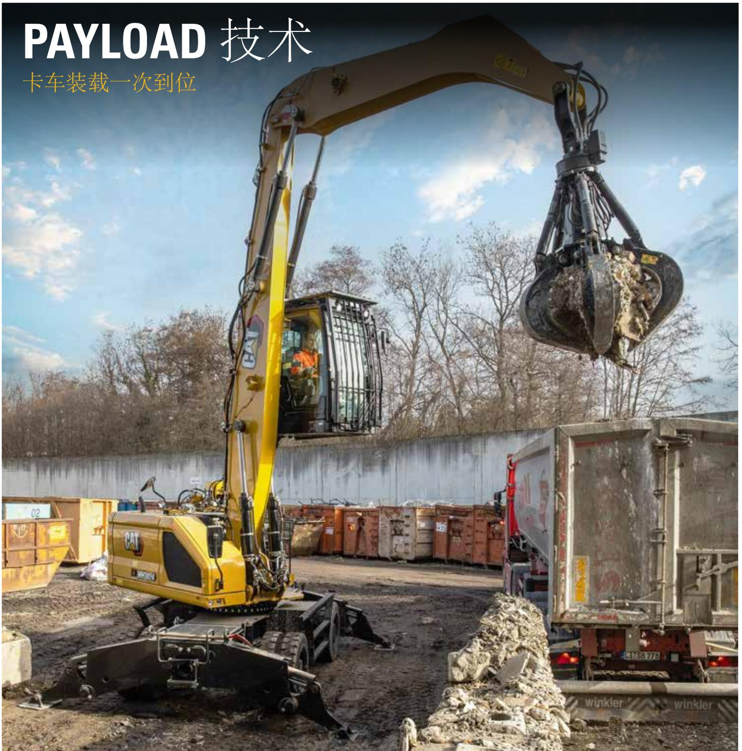
Cat Payload 技术提供车载有效负载称量功能以及重要的生产测量和物料跟踪数据。这些数据可用于单个机器，也可以提供宝贵的设备机群运营效率数据。
