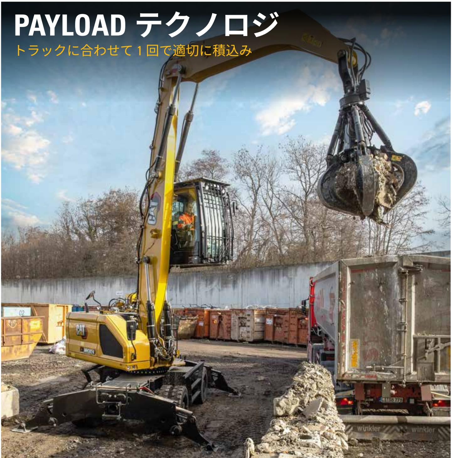
CAT PAYLOAD テクノロジーは、積載質量の車載計量機能を備え、価値ある生産性の測定およびマテリアルの追跡データを提供します。このデータでは、各機械に加えて、価値あるフリート全体の運用効率も提示できます。
