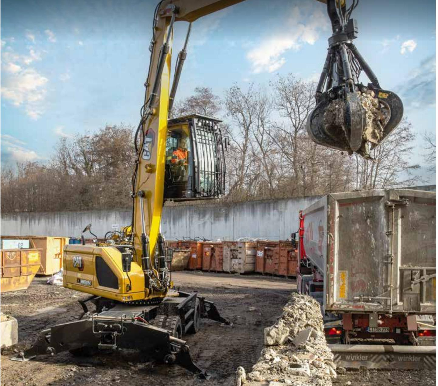
La technologie Cat Payload permet de peser la charge utile à bord et d'obtenir de précieuses données de mesure de la production et de suivi des matériaux. Ces données sont disponibles pour les machines individuelles, mais elles peuvent aussi fournir des données précieuses sur l'efficacité opérationnelle de l'ensemble de la flotte.
