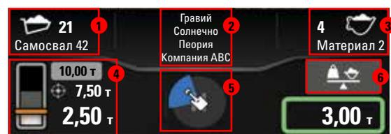
Области быстрого доступа на сенсорном экране позволяют операторам быстро получать доступ к ключевым функциям меню:
