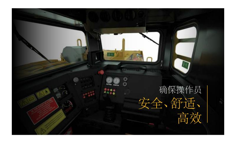
机器的生产率取决于操作员, R3000H 设计旨在为操作员提供尽可能高效、安全和舒适的所需工具。
