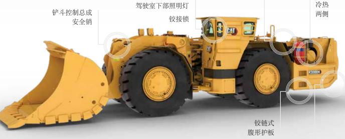
可从地面进行操作的3个发动 机停机开关
