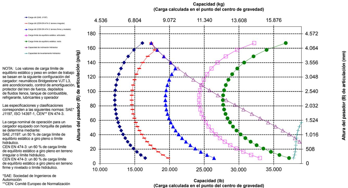
NOTA: Los valores de carga límite de equilibrio estático y peso en orden de trabajo se basan en la siguiente configuración del cargador: neumáticos Bridgestone VJT L3, aire acondicionado, control de amortiguación, protector del tren de fuerza, depósitos de fluidos llenos, tanque de combustible, refrigerante, lubricantes y operador
