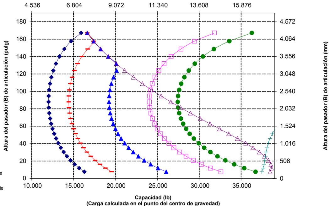
NOTA: Los valores de carga límite de equilibrio estático y peso en orden de trabajo se basan en la siguiente configuración del cargador: neumáticos Bridgestone VJT L3, aire acondicionado, control de amortiguación, protector del tren de fuerza, depósitos de fluidos llenos, tanque de combustible, refrigerante, lubricantes y operador.
