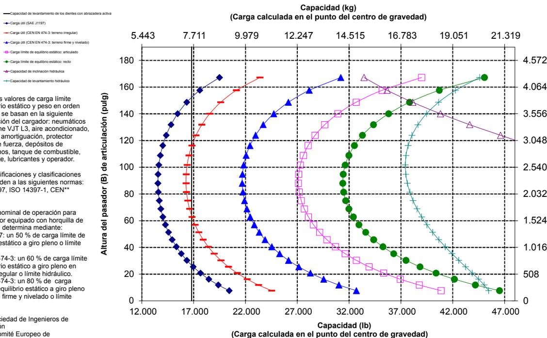
NOTA: Los valores de carga límite de equilibrio estático y peso en orden de trabajo se basan en la siguiente configuración del cargador: neumáticos Bridgestone VJT L3, aire acondicionado, control de amortiguación, protector del tren de fuerza, depósitos de fluidos llenos, tanque de combustible, refrigerante, lubricantes y operador.
