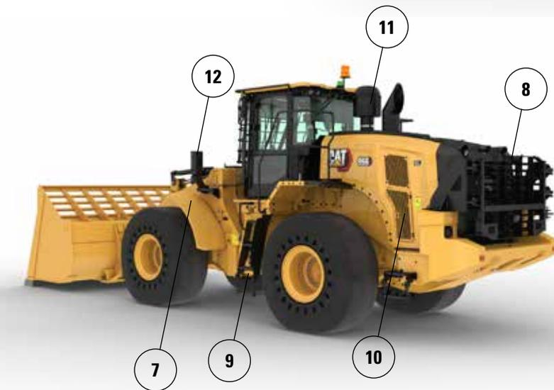
7. Los guardabarros delanteros estrechos de acero ayudan a mantener el parabrisas limpio y se colocan en el interior del borde exterior del neumático para una mayor protección.
