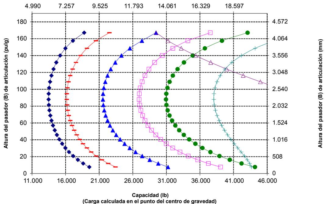
NOTA: Los valores de carga límite de equilibrio estático y peso en orden de trabajo se basan en la siguiente configuración del cargador: neumáticos Bridgestone VJL L3, aire acondicionado, control de amortiguación, protector del tren de fuerza, depósitos de fluidos llenos, tanque de combustible, refrigerante, lubricantes y operador.
