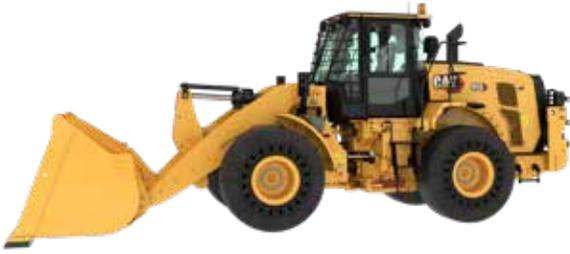
**La Chargeuse sur pneus pour le traitement des déchets 950 Cat est dotée des protections et renforts nécessaires pour le travail dans les stations de transfert, le recyclage des dépôts, les dépôts de ferraille et les chantiers de démolition.**
