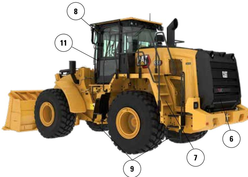
6. Interruptores de parada del motor y anulación del freno de estacionamiento a nivel del suelo.
