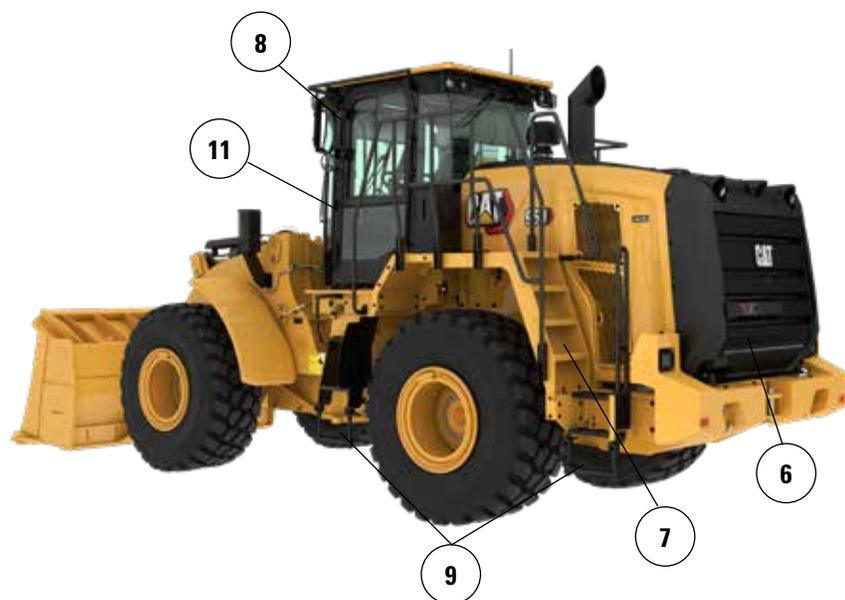
6. Доступный с уровня земли стояночный тормоз переопределяет выключатели двигателя для останова машины в экстренных ситуациях.
