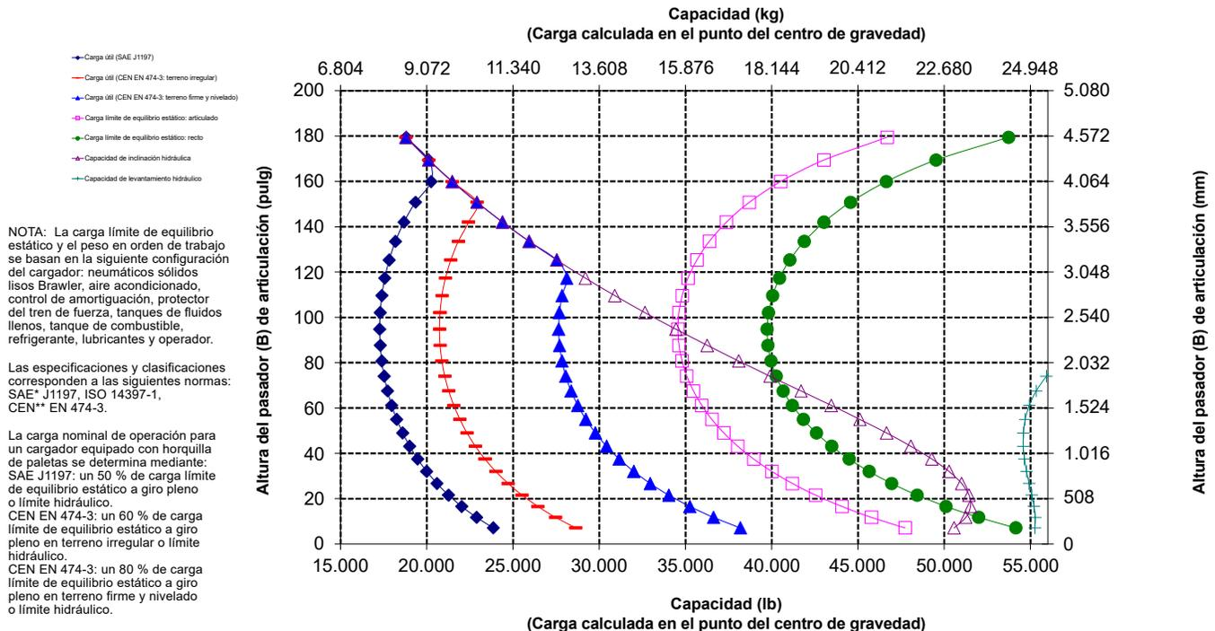
NOTA: La carga límite de equilibrio estático y el peso en orden de trabajo se basan en la siguiente configuración del cargador: neumáticos sólidos lisos Brawley, aire acondicionado, control de amortiguación, protector del tren de fuerza, tanques de fluidos llenos, tanque de combustible, refrigerante, lubricantes y operador.
