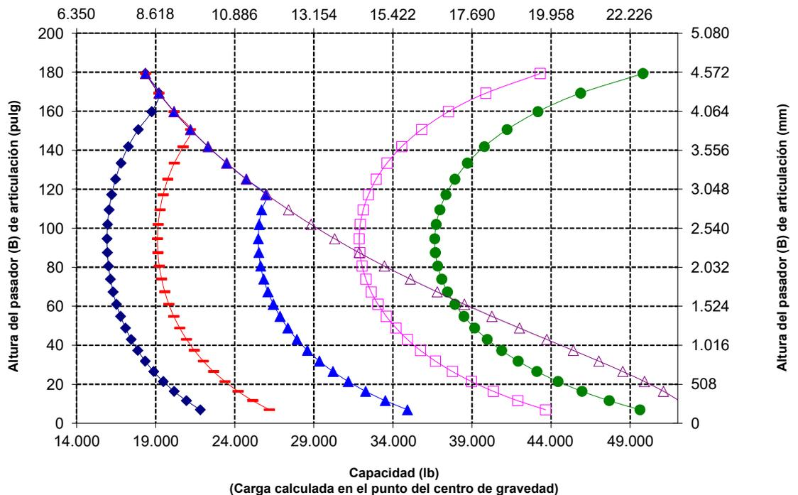
NOTA: La carga límite de equilibrio estático y el peso en orden de trabajo se basan en la siguiente configuración del cargador: neumáticos Bridgestone VSNT L4, aire acondicionado, control de amortiguación, protector del tren de fuerza, tanques de fluidos llenos, tanque de combustible, refrigerante, lubricantes y operador.
