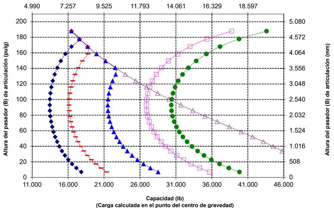
NOTA: La carga límite de equilibrio estático y el peso en orden de trabajo se basan en la siguiente configuración del cargador: neumáticos Bridgestone\* VSNT L4, aire acondicionado, control de amortiguación, protector del tren de fuerza, tanques de fluidos llenos, tanque de combustible, refrigerante, lubricantes y operador.
