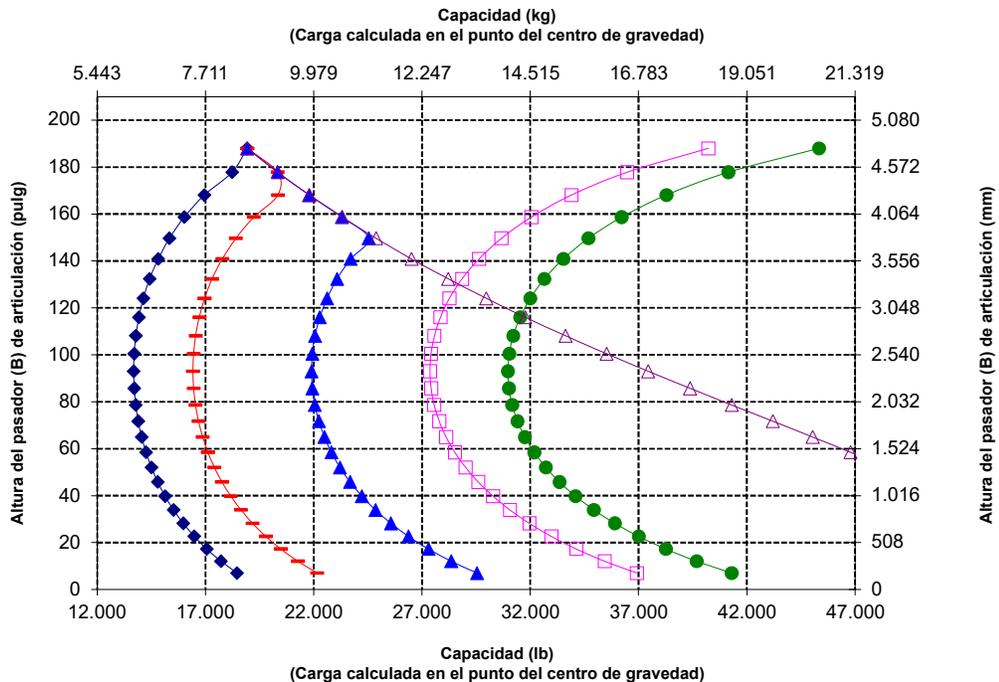
**NOTA:** La carga límite de equilibrio estático y el peso en orden de trabajo se basan en la siguiente configuración del cargador: neumáticos Bridgestone® VSNT L4, aire acondicionado, control de amortiguación, protector del tren de fuerza, tanques de fluidos llenos, tanque de combustible, refrigerante, lubricantes y operador.
