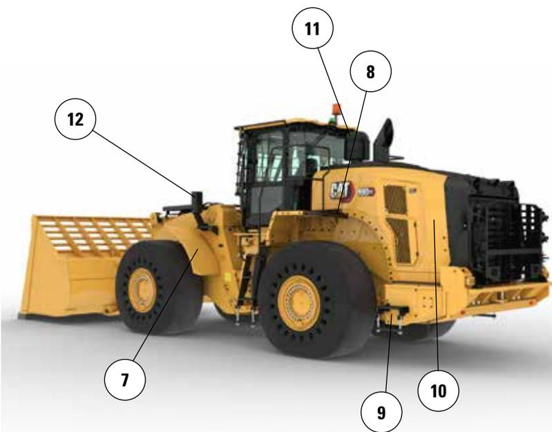
7. Los guardabarros delanteros estrechos de acero ayudan a mantener el parabrisas limpio y se colocan en el interior del borde exterior del neumático para una mayor protección.
