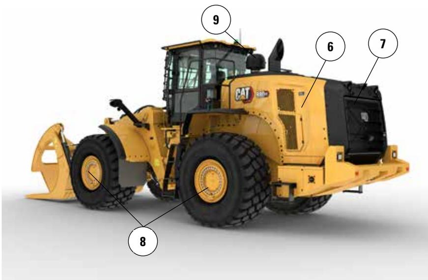
6. La ventola a passo variabile a richiesta aiuta a mantenere la griglia posteriore e le masse radianti di raffreddamento pulite nelle applicazioni con volumi elevati di detriti
