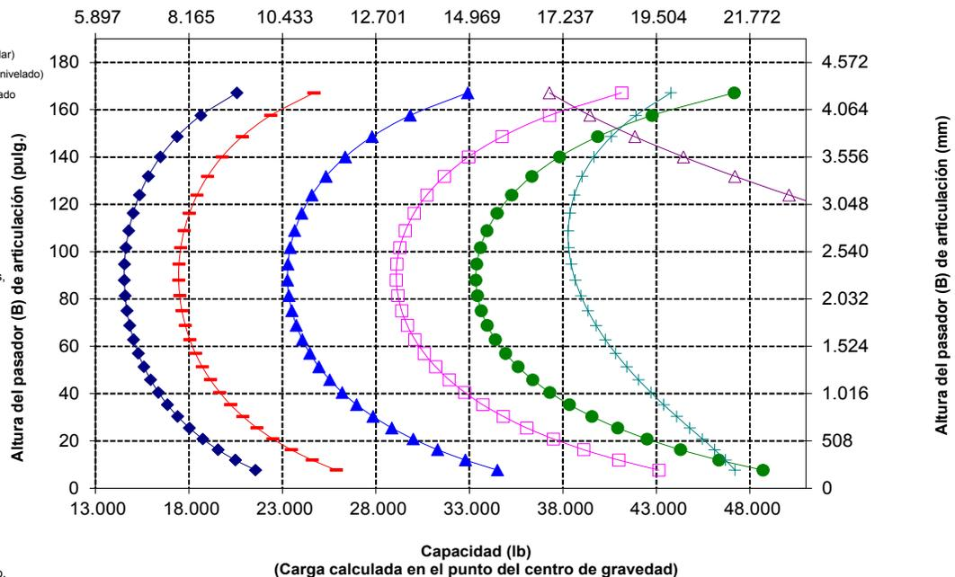
NOTA: La carga límite de equilibrio estático y el peso en orden de trabajo se basan en la siguiente configuración del cargador: neumáticos Bridgestone VJT L3, aire acondicionado, control de amortiguación, protector del tren de fuerza, depósitos de fluidos llenos, tanque de combustible, refrigerante, lubricantes y operador.
