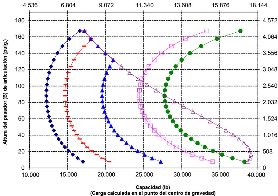
NOTA: Los valores de carga límite de equilibrio estático y peso en orden de trabajo se basan en la siguiente configuración del cargador: neumáticos Bridgestone VJ T L3, aire acondicionado, control de amortiguación, protector del tren de fuerza, depósitos de fluidos llenos, tanque de combustible, refrigerante, lubricantes y operador.
