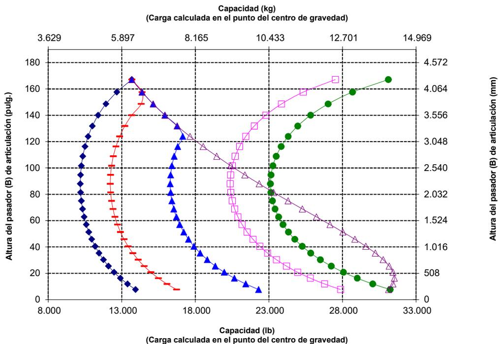
NOTA: Los valores de carga límite de equilibrio estático y peso en orden de trabajo se basan en la siguiente configuración del cargador: neumáticos Bridgestone VIT L3, aire acondicionado, control de amortiguación, protector del tren de fuerza, depósitos de fluidos llenos, tanque de combustible, refrigerante, lubricantes y operador.
