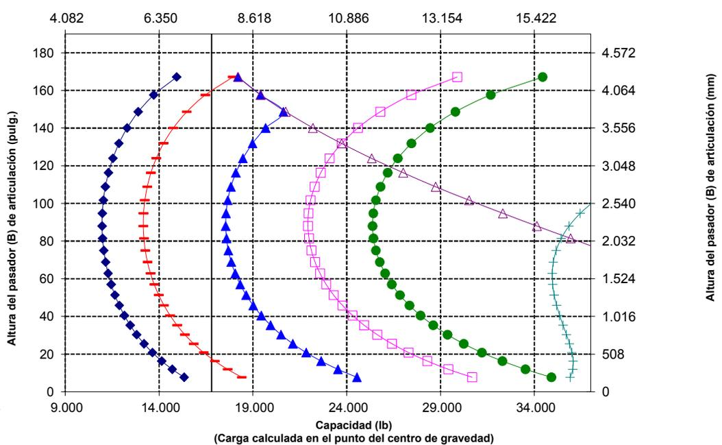
NOTA: Los valores de carga límite de equilibrio estático y peso en orden de trabajo se basan en la siguiente configuración del cargador: neumáticos Bridgestone VJ1 L3, aire acondicionado, control de amortiguación, protector del tren de fuerza, depósitos de fluidos llenos, tanque de combustible, refrigerante, lubricantes y operador.
