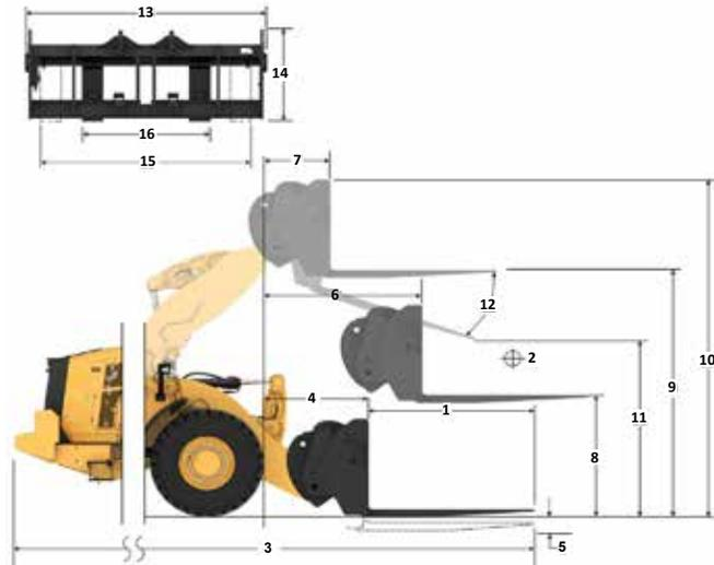
NOTA: Los valores de carga límite de equilibrio estático y peso en orden de trabajo se basan en la siguiente configuración del cargador: neumáticos Bridgestone VJT L3, aire acondicionado, control de amortiguación, protector del tren de fuerza, depósitos de fluidos llenos, tanque de combustible, refrigerante, lubricantes y operador.
