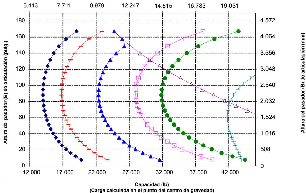
NOTA: Los valores de carga límite de equilibrio estático y peso en orden de trabajo se basan en la siguiente configuración del cargador: neumáticos Bridgestone VJIT L3, aire acondicionado, control de amortiguación, protector del tren de fuerza, depósitos de fluidos llenos, tanque de combustible, refrigerante, lubricantes y operador.
