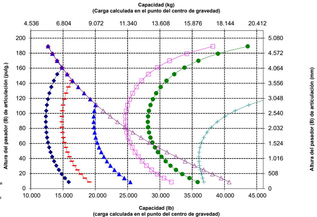
NOTA: Los valores de carga límite de equilibrio estático y peso en orden de trabajo se basan en la siguiente configuración del cargador: neumáticos Bridgestone VJT L3, aire acondicionado, control de amortiguación, protector del tren de fuerza, depósitos de fluidos llenos, tanque de combustible, refrigerante, lubricantes y operador.
