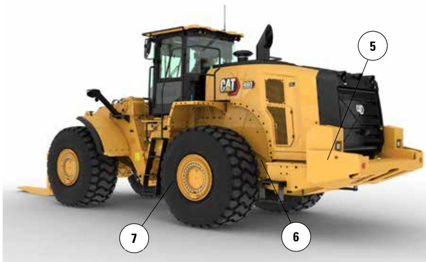
5. Das schwerere Kontergewicht ermöglicht höhere Kipplasten, und der integrierte Kontergewichtschutz schützt das Kontergewicht vor Stößen.
