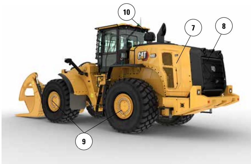
7. La ventola a passo variabile a richiesta aiuta a mantenere la griglia posteriore e le masse radianti di raffreddamento pulite nelle applicazioni con volumi elevati di detriti
