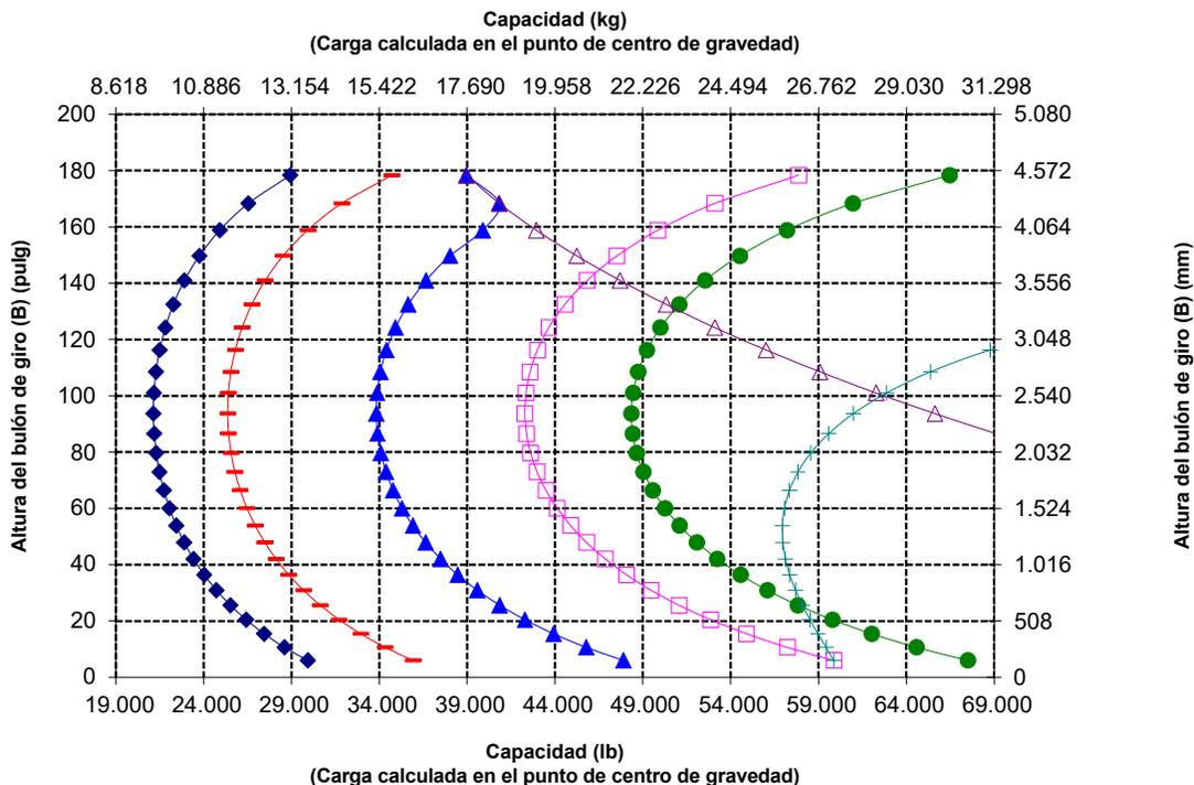
NOTA: Las cargas límite de equilibrio estático y el peso de funcionamiento se basan en la siguiente configuración de pala: neumáticos Bridgestone\*\* VJT L3, aire acondicionado, control de amortiguación, protector del tren de potencia, todos los fluidos, depósito de combustible, refrigerante, lubricantes y operador.
