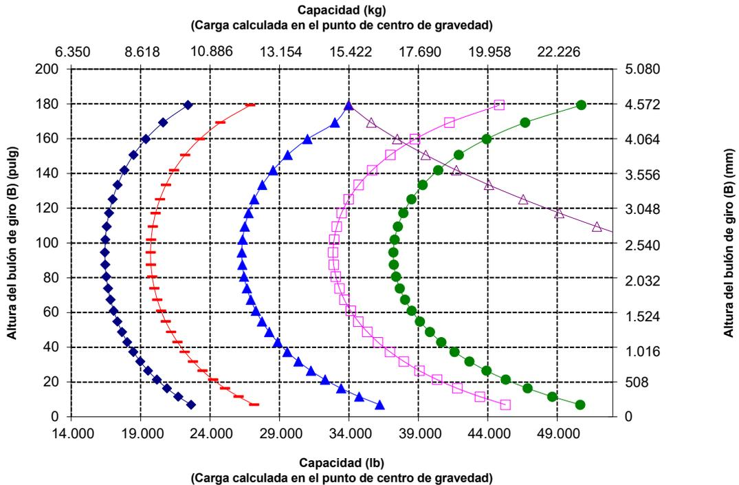
NOTE: Las cargas límite de equilibrio estático y el peso de funcionamiento se basan en la siguiente configuración de pala: neumáticos Bridgestone \* VSNT L4, aire acondicionado, control de amortiguación, protector del tren de potencia, todos los líquidos, depósito de combustible, refrigerante, lubricantes y operador.
