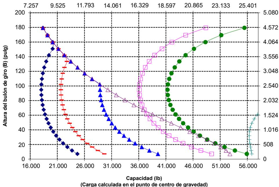
NOTA: Las cargas límite de equilibrio estático y el peso de funcionamiento se basan en la siguiente configuración de pala: neumáticos Brawler Smooth Solid, aire acondicionado, control de amortiguación, protector del tren de potencia, todos los líquidos, depósito de combustible, refrigerante, lubricantes y operador.
