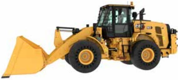
**La chargeuse sur pneus pour le traitement des déchets 962 Cat est dotée des protections et renforts nécessaires pour le travail dans les stations de transfert, le recyclage des dépôts, les dépôts de ferraille et les chantiers de démolition.**
