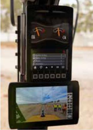
Die Überwachung der nächsten Generation stellt über die konsolidierte Benutzeroberfläche den Maschinenstatus in Echtzeit zur Verfügung. Die weichen Touch-Elemente gewähren einfachen Zugriff auf Maschinensteuerungsoptionen, darunter Sicherheitscodes, Wartungsintervalle und Einstellungen zur Arbeitsgerät-/Antriebsstrangleistung und dem Ansprechverhalten.
