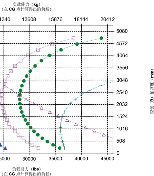
注: 静态倾翻负载与工作重量基于以下装载机配置: Bridgestone VJT L3 轮胎、空调、行驶控制装置、动力传动系护罩、加满的油液、燃油箱、冷却液、润滑油和操作员。
