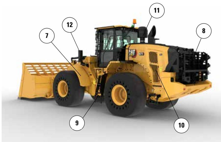
7. 前侧的窄挡泥钢板有助于保持挡风玻璃清洁, 并安装在轮胎外缘板上以增加保护
