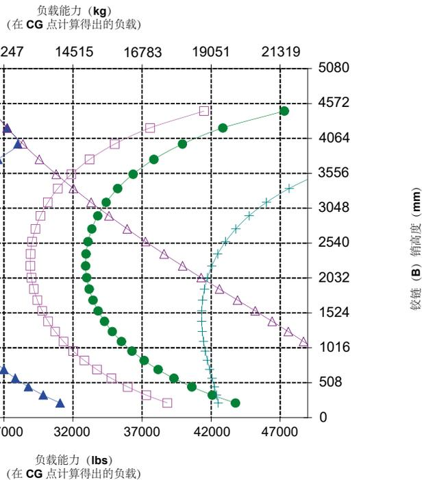
注: 静态倾翻负载与工作重量基于以下装载机配置: Bridgestone VJT L3 轮胎、空调、行驶控制装置、动力传动系护罩、加满的油液、燃油箱、冷却液、润滑油和操作人员。
