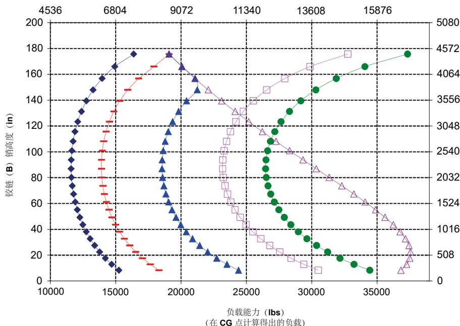
注: 静态倾翻负载与工作重量基于以下装载机配置: Bridgestone VJT L3 轮胎、空调、行驶控制装置、动力传动系护罩、加满的油液、燃油箱、冷却液、润滑油和操作人员。
