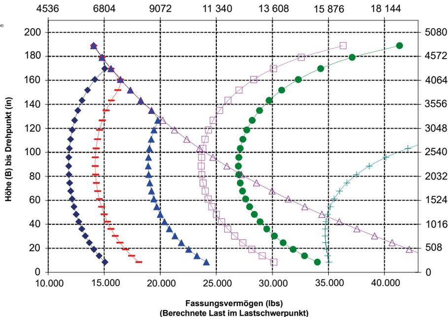
ANMERKUNG: Die Angaben zur statischen Kipplast und zum Einsatzgewicht gelten für folgende Laderkonfiguration: Bridgestone VJT L3 Reifen, Klimaanlage, hydraulische Schwingungsämpfung, Antriebsstrangschutz, Betriebsflüssigkeiten, Kraftstofftank, Kühlmittel, Schmierstoffe und Fahrer.
