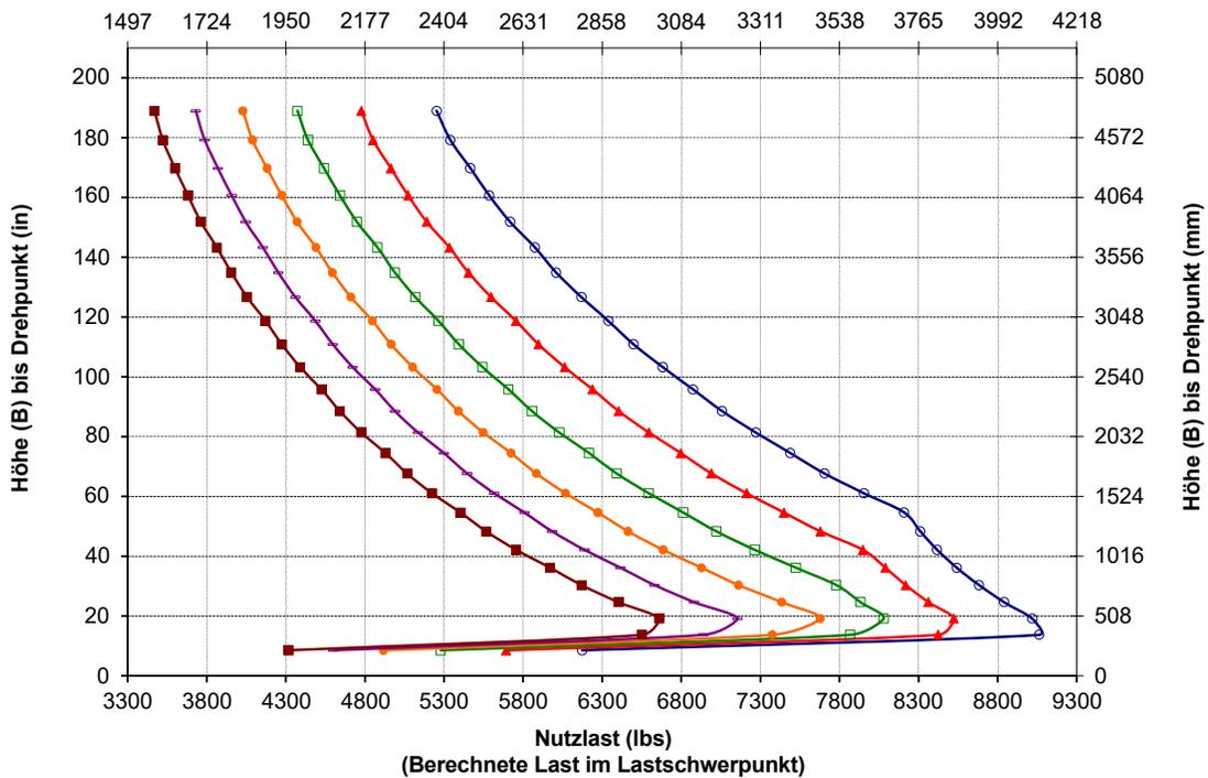
**ANMERKUNG:** Die statischen Kipplasten und das Einsatzgewicht basieren auf folgender Lader-Konfiguration: Reifen Bridgestone VJT L3, Klimaanlage, hydraulische Schwingungsdämpfung, Antriebsstrangschutz, alle Betriebsflüssigkeiten, Kraftstofftank, Kühlmittel, Schmierstoffe und Fahrer.
