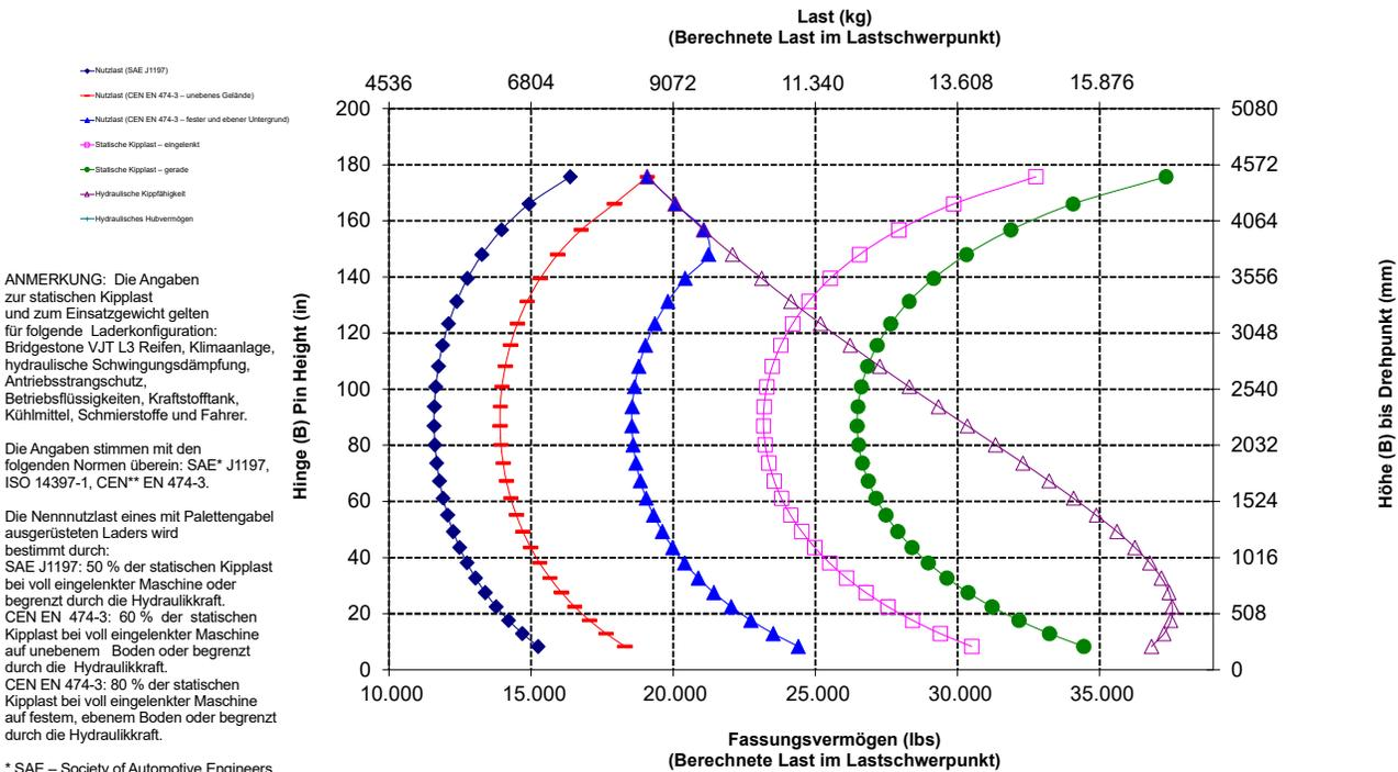
ANMERKUNG: Die Angaben zur statischen Kipplast und zum Einsatzgewicht gelten für folgende Laderkonfiguration: Bridgestone VJT L3 Reifen, Klimaanlage, hydraulische Schwingungsdämpfung, Antriebsstrangschutz, Betriebsflüssigkeiten, Kraftstofftank, Kühlmittel, Schmierstoffe und Fahrer.
