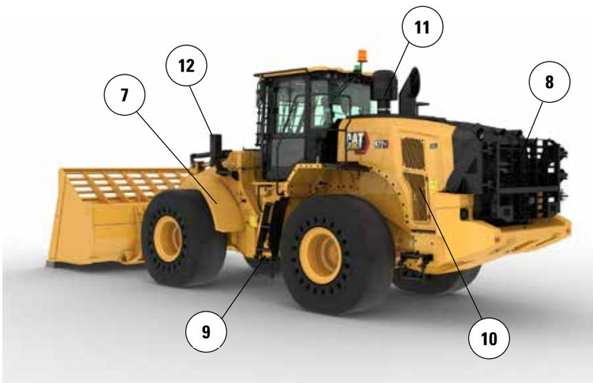
7. Die schmalen vorderen Kotflügel aus Stahl halten den Schmutz von der Windschutzscheibe ab und gewähren zusätzlichen Schutz durch die nach innen gerichtete Montage am äußeren Rand des Reifens.
