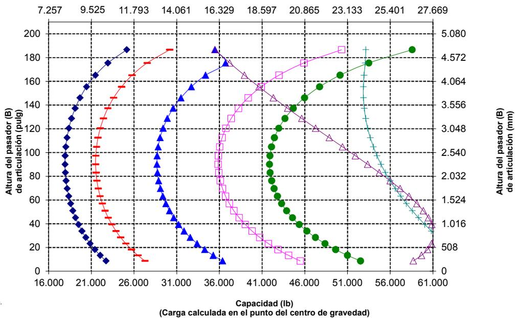
**NOTA:** Las cargas límite de equilibrio estático y el peso en orden de trabajo se basan en la siguiente configuración del cargador: neumáticos Bridgestone® VLTS L4, aire acondicionado, control de amortiguación, protector del tren de fuerza, tanques de fluidos llenos, tanque de combustible, refrigerante, lubricantes y operador.
