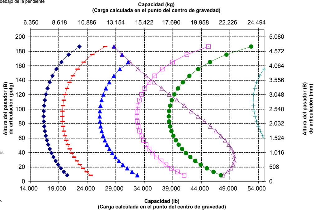
**NOTA:** Las cargas límite de equilibrio estático y el peso en orden de trabajo se basan en la siguiente configuración del cargador: neumáticos Bridgestone® VLTS L4, aire acondicionado, control de amortiguación, protector del tren de fuerza, tanques de fluidos llenos, tanque de combustible, refrigerante, lubricantes y operador.
