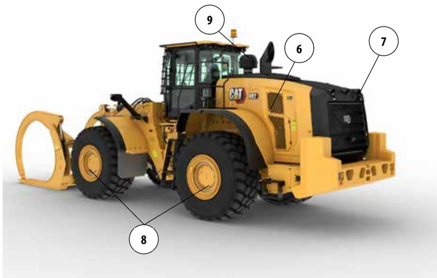
6. Дополнительный вентилятор с переменным шагом помогает поддерживать чистоту задней решетки и охлаждающих элементов в условиях большого скопления мусора.
