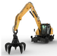
GRAAFMACHINES IN OVERSLAGUITVOERING
