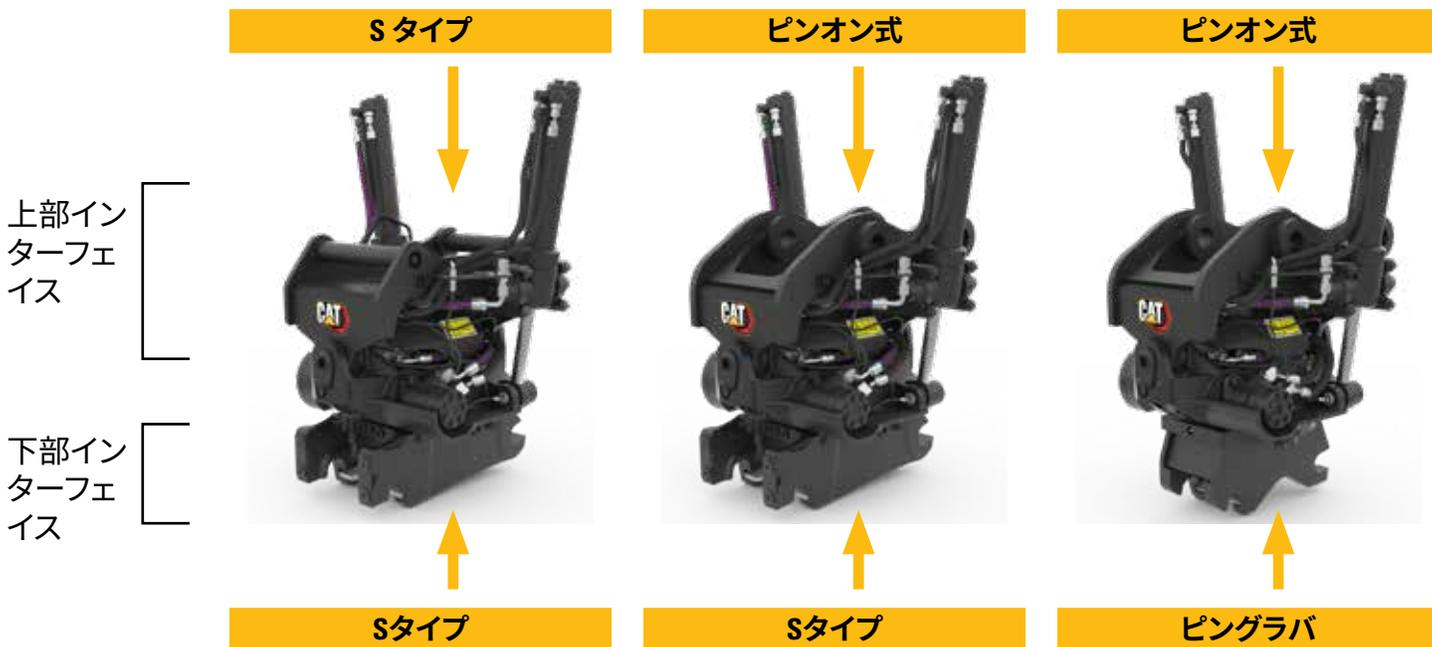
Sタイプの下部インターフェイスでは、業界標準サイズのSカプラを使用します。これにより、Sタイプのアタッチメントを装着できます。Sタイプの下部インターフェイスは、オプションの一体型グラップルと互換性があります。ピングラバの下部インターフェイスは、標準の Dual Lock ピングラバカプラを使用します。インターフェイス上のピンでアタッチメントに装着できます。ピングラバの下部インターフェイスは、オプションの一体型グラップルと互換性はありません。
