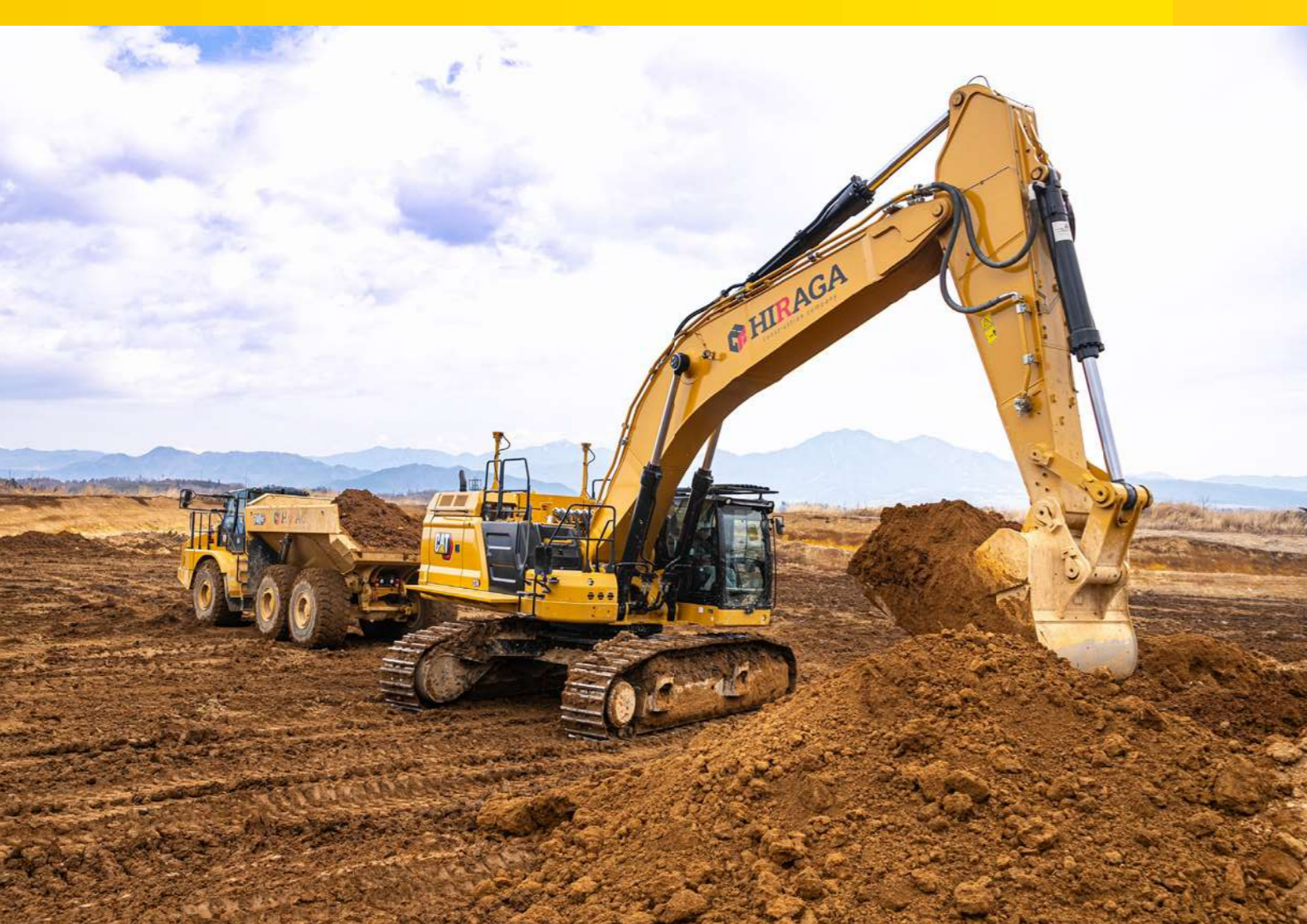
ICT建機としていち早く導入した320を筆頭に、現在は25台のCatマシンがICTに対応。 ※写真は374(前)と740GC(後)
