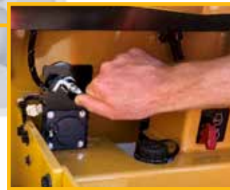
Interruptor de funcionamiento manual a remoto
