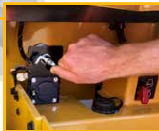
Interruttore per passare dal funzionamento manuale a quello a distanza
