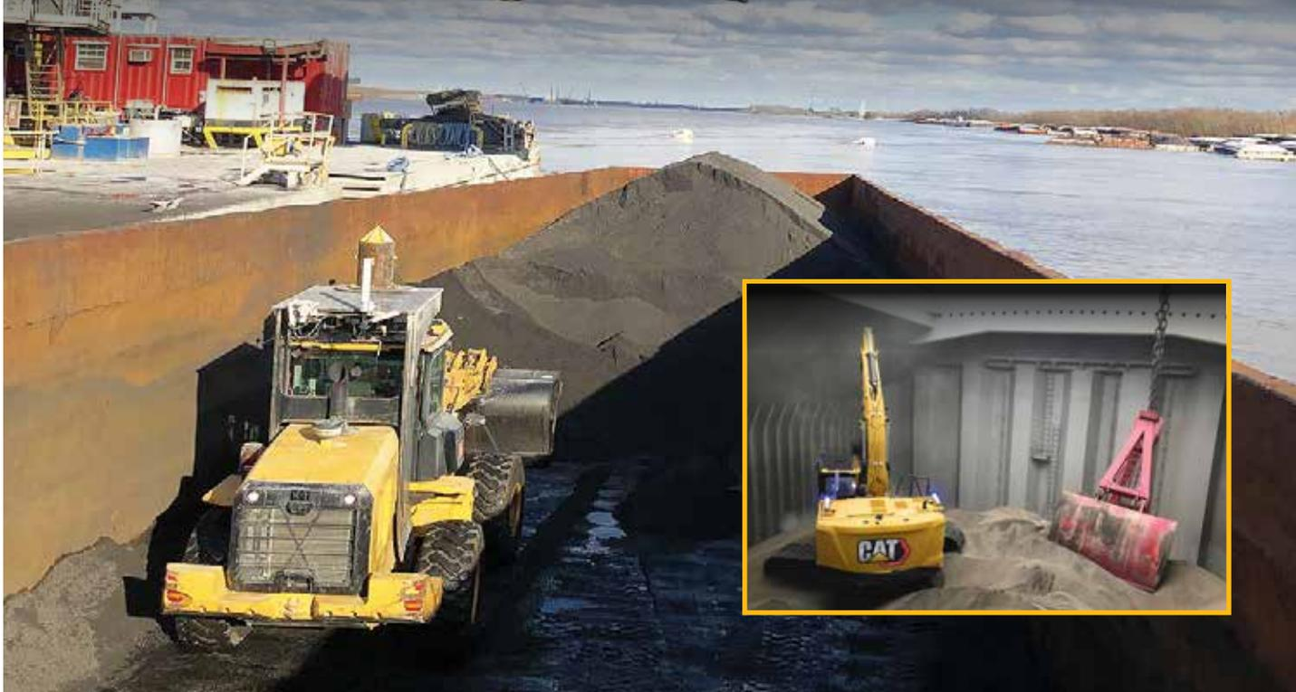
**Associated Terminals, una empresa de manejo y logística de cargamentos que tiene instalaciones en la costa del Golfo de Luisiana (EE.UU.), utiliza la Estación Cat Command para operar cargadores de ruedas y excavadoras.**
