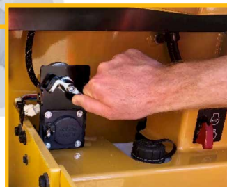
Contacteur pour basculer entre la commande manuelle et la commande à distance
