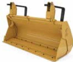
Godet tous-travaux à inclinaison simple avec lame de coupe à boulonner et fourches
