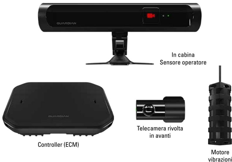
L'hardware Cat Detect DSS in cabina è un sistema completo che comprende un sensore rivolto verso l'operatore che rileva i cambiamenti del viso e degli occhi, un modulo di controllo elettronico (ECM), un motore a vibrazione e una telecamera rivolta in avanti\* che fornisce un video degli eventi che si verificano davanti al veicolo.
