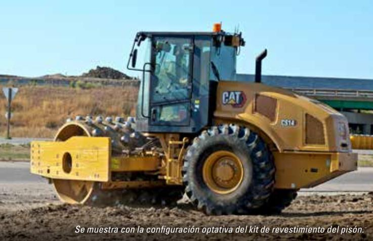
Se muestra con la configuración optativa del kit de revestimiento del pison.
