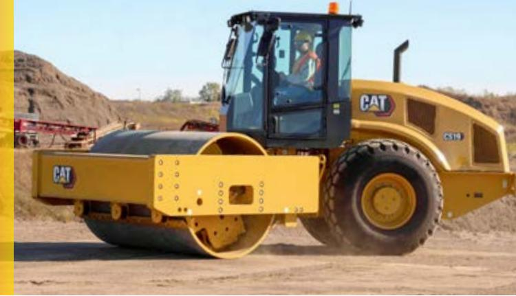
يتميز ضاغط التربة الاهتزازي Cat® CS19 بأسطوانة ناعمة، كما أنه يُعد مثالياً لاستخدامات التربة الحبيبية أو استخدامات التربة اللاصقة من خلال استخدام طقم الحاوية الواقية ذات الأقدام البارزة الاختياري. يعمل نظام الدفع الموثوق به على تحسين الأداء والكفاءة، ويساعد الحلول التقنية للضغط على الوصول إلى الكثافة المستهدفة بشكل أسرع.
