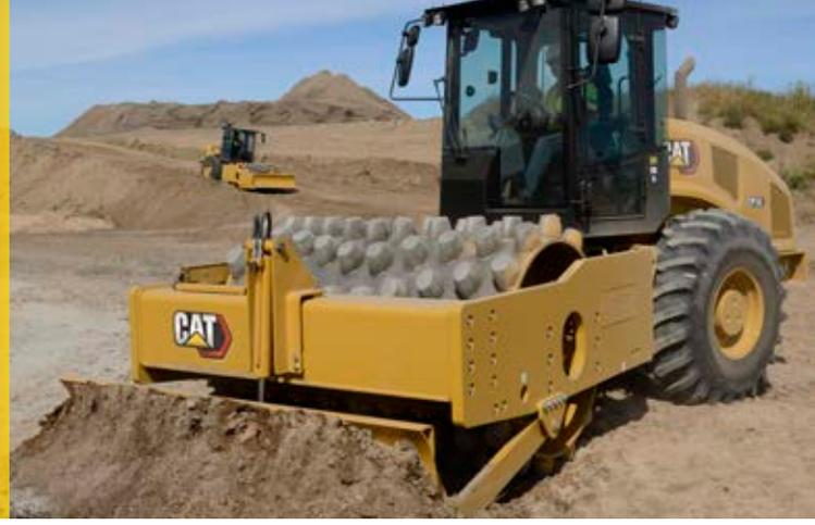
يتميز ضاغط التربة الاهتزازي Cat® CP14 بأسطوانة ذات أقدام بارزة، وهي مثالية لاستخدامات التربة اللاصقة وشبه اللاصقة. يعمل نظام الدفع الموثوق به على تحسين الأداء والكفاءة، وتساعد الحلول التقنية للضغط على الوصول إلى الكثافة المستهدفة بشكل أسرع.
