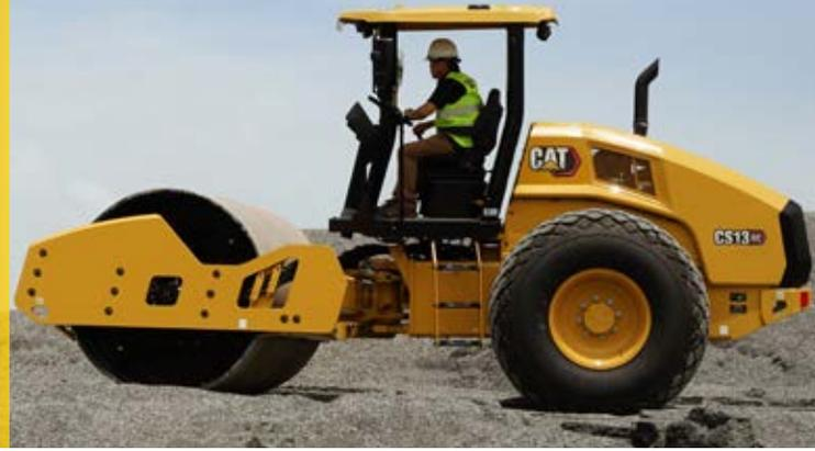
توفر ضوغط التربة الاهتزازية Cat® CS13 GC التوازن بين التشغيل السهل، وتكاليف التشغيل المنخفضة، وتقنية تعزيز الأداء في موقع العمل. وباستخدام نظام اهتزازي موكد الكفاءة تم تصميمه لضمان الموثوقية العالية، فإن البكرة الأسطوانية الملساء CS13 GC مناسبة بشكل مثالي للاستخدامات في التربة الحبيبية أو الأعمال التي تتم في التربة المتماسكة مع استخدام الطقم الاختيارية لأغلفة الأقدام البارزة.
