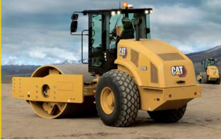
يتميز ضاغط التربة الاهتزازي Cat® CS16 بأسطوانة ناعمة، كما أنه يُعد مثالياً لاستخدامات التربة الحبيبية أو استخدامات التربة اللاصقة من خلال استخدام طقم الحاوية الواقية ذات الأقدام البارزة الاختياري. يعمل نظام الدفع الموثوق به على تحسين الأداء والكفاءة، ويساعد الحلول التقنية للضغط على الوصول إلى الكثافة المستهدفة بشكل أسرع.
