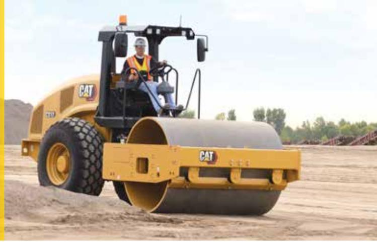
يتميز ضاغط التربة الاهتزازي Cat® CS12 بأسطوانة ناعمة، كما أنه يُعد مثاليًا لاستخدامات التربة الحبيبية أو استخدامات التربة اللاصقة من خلال استخدام طقم الحاوية الواقية ذات الأقدام البارزة الاختياري. يعمل نظام الدفع الموثوق به على تحسين الأداء والكفاءة، وتُساعد الحلول التقنية للضغط على الوصول إلى الكثافة المستهدفة بشكل أسرع.
