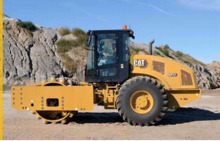
يتميز ضاغط التربة الاهتزازي Cat® CP17 بأسطوانة ذات أقدام بارزة، وهي مثالية لاستخدامات التربة اللاصقة وشبيه اللاصقة. يعمل نظام الدفع الموثوق به على تحسين الأداء والكفاءة، ويساعد الحلول التقنية للضغط على الوصول إلى الكثافة المستهدفة بشكل أسرع.
