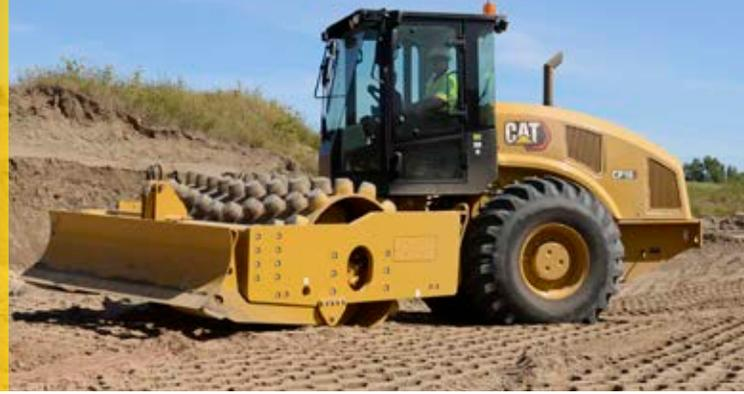
يتميز ضاغط التربة الاهتزازي Cat® CP16 بأسطوانة ذات أقدام بارزة، وهي مثالية لاستخدامات التربة اللاصقة وشبه اللاصقة. يعمل نظام الدفع الموثوق به على تحسين الأداء والكفاءة، وتساعد الحلول التقنية للضغط على الوصول إلى الكثافة المستهدفة بشكل أسرع.
