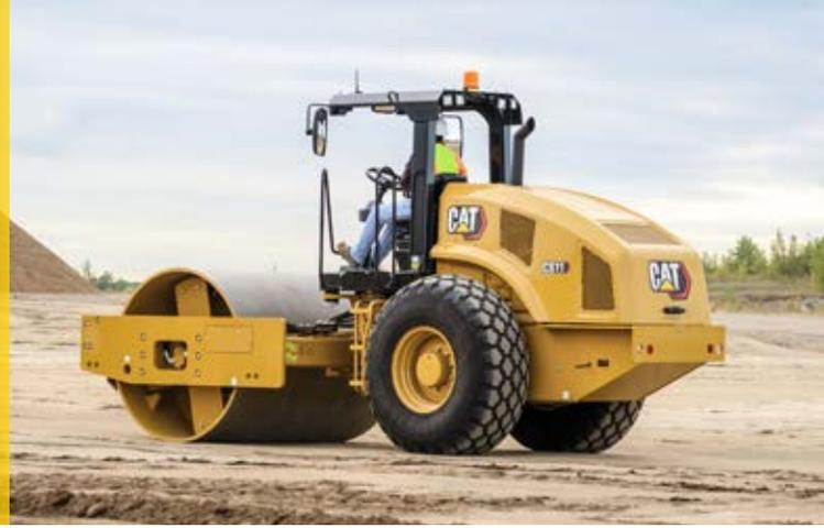
يتميز ضاغط التربة الاهتزازي Cat® CS11 بأسطوانة ناعمة، كما أنه يُعد مثاليًا لاستخدامات التربة الحبيبية أو استخدامات التربة اللاصقة من خلال استخدام طقم الحاوية الواقية ذات الأقدام البارزة الاختياري. يعمل نظام الدفع الموثوق به على تحسين الأداء والكفاءة، وتُساعد الحلول التقنية للضغط على الوصول إلى الكثافة المستهدفة بشكل أسرع.
