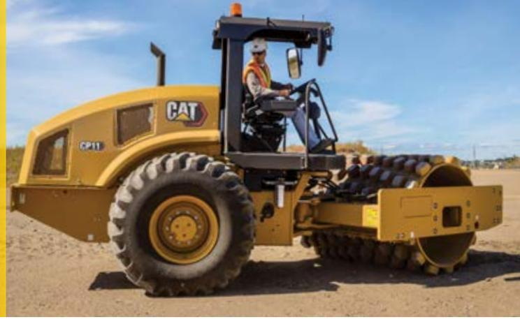
يتميز ضاغط التربة الاهتزازي Cat® CP11 بأسطوانة ذات أقدام بارزة، وهي مثالية لاستخدامات التربة اللاصقة وشبه اللاصقة. يعمل نظام الدفع الموثوق به على تحسين الأداء والكفاءة، وتساعد الحلول التقنية للضغط على الوصول إلى الكثافة المستهدفة بشكل أسرع.
