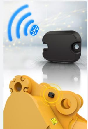
사용 가능한 작업 도구 인식 기능으로 더 많은 시간과 에너지를 절약하십시오. 부착된 도구를 가볍게 흔들어서 정체성을 확인합니다. 또한 모든 어택치먼트 설정이 올바른지 확인하여 빠르고 효율적으로 작업할 수 있습니다.
