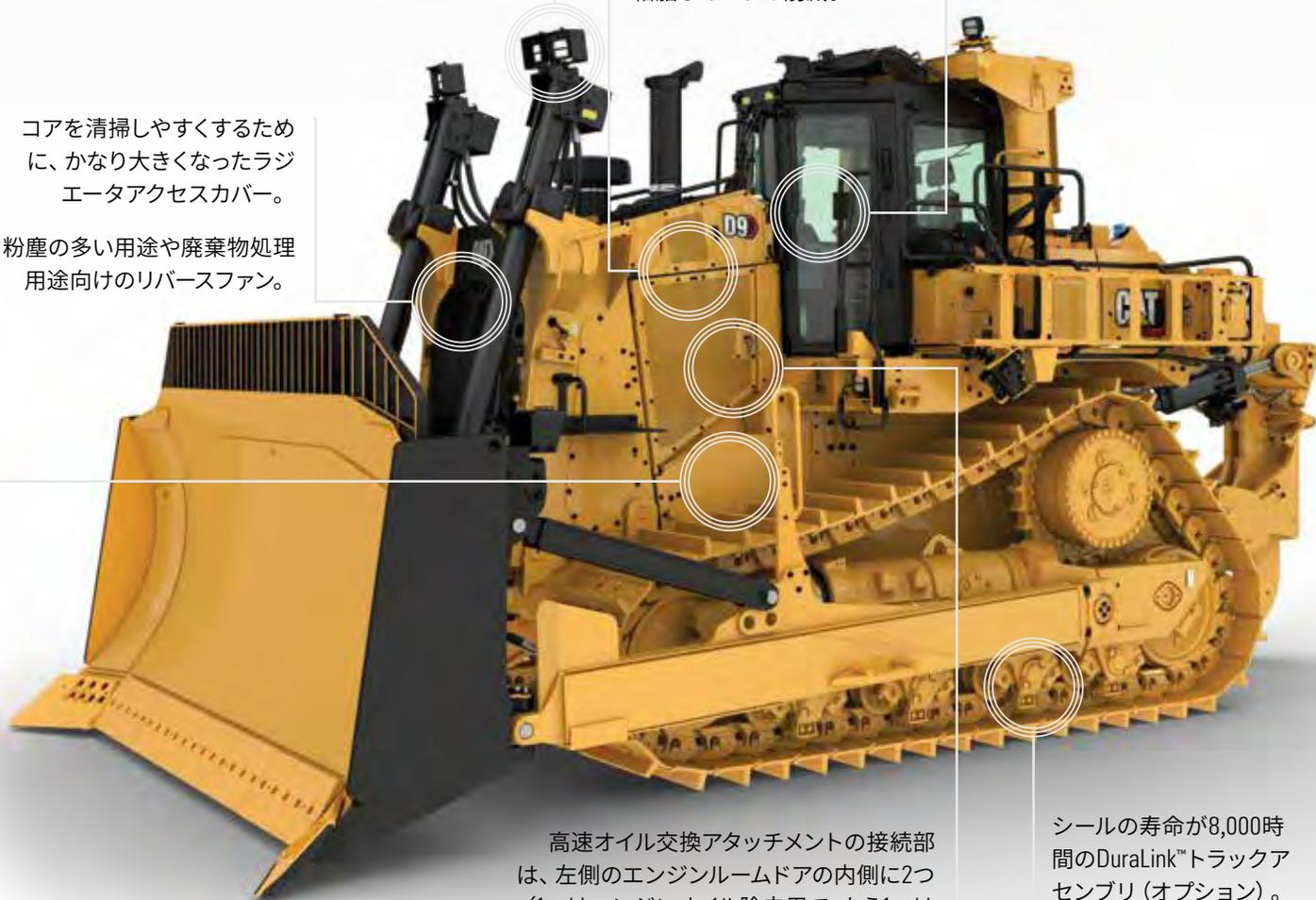
高速オイル交換アタッチメントの接続部は、左側のエンジンルームドアの内側に2つ（1つはエンジンオイル除去用で、もう1つはパワートレインオイル用）。ポンプ車を使用してオイルを迅速に除去可能。
