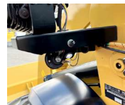
ウェルカムランプ (標準) キャブドアの開閉に連動
